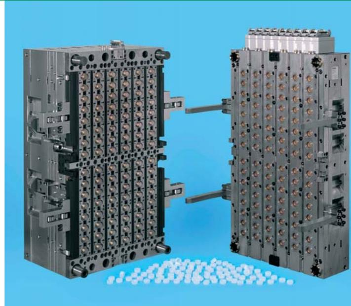
Das Abmattern von Multikavitätenwerkzeugen mit Materialmischungen geht deutlich einfacher und schneller, wenn die Komponenten am Einzug der Spritzgießmaschine exakt dosiert werden (links). Rechts: 96-fach Fostag-Werkzeug für Wasserverschluss 30/25 mit 1,7 g Formteilgewicht; Zykluszeit: 3,3 s.
