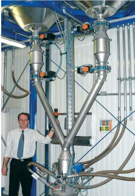
Thomas Schrenkhammer: „Die Online-Durchsatzmessung an den beiden 1.200-Liter-Trichtern ermöglicht uns, die erforderliche Trockenzeit gesichert und gleichmäßig einzuhalten.“
