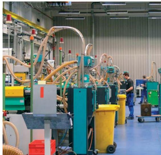
In „Kleinmengen“ benötigte, häufig wechselnde Materialien werden an den jeweiligen Spritzgießmaschinen mit Beistelltrocknern SOMOS® TF (mit integrierter Förderung) getrocknet.
