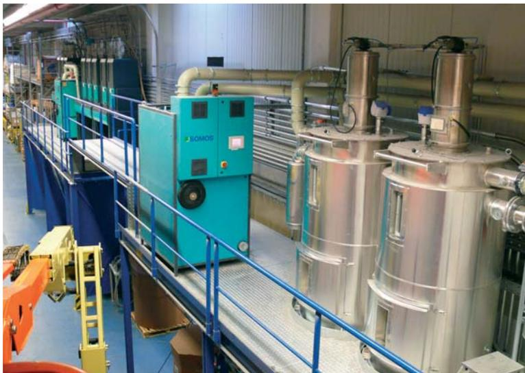
Die mit Oktabs (unter der Bühne) bereitgestellten und zentral getrockneten Materialien werden in materialbezogenen Leitungen an die Spritzgießmaschinen gefördert (Bild links). Im Einsatz sind zwei Trockenanlagen mit je einem Trockenlufttrockner SOMOS® D 600: Einer versorgt acht Trocknungstrichter mit je 400 l Inhalt (auf der Bühne hinten) und der zweite zwei 1.200 l-Trichter (vorn) mit Trockenluft.
