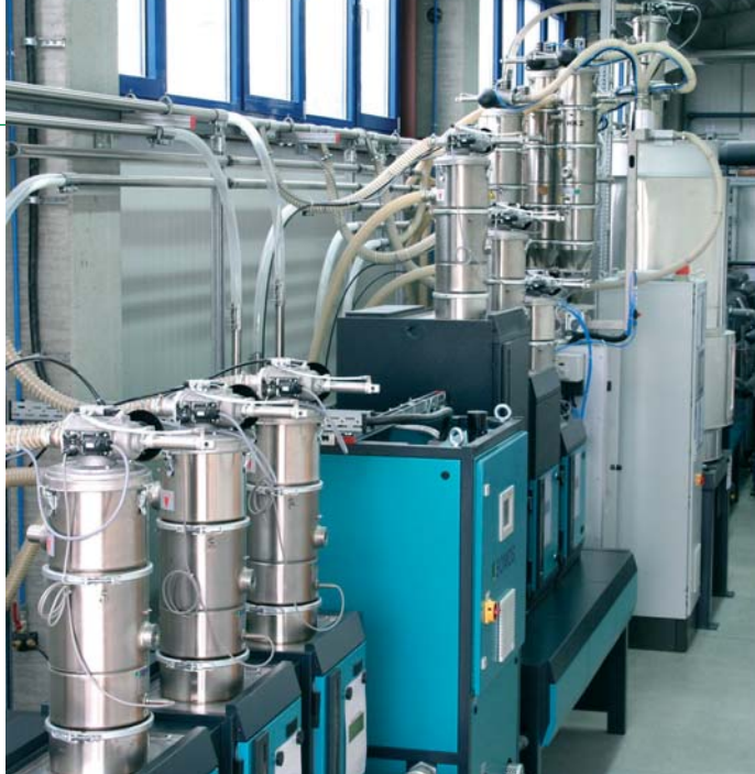
Somos®-Technologie zum Aufbereiten von Materialmischungen (links) bietet Technoform Extrusion Tooling hohe Flexibilität beim Abmattern hochgenauer Profilwerkzeuge. Mit diesen Werkzeugen produziert das Schwesterunternehmen Technoform Bautech eine große Bandbreite an Kunststoffprofilen bis hin zu komplexen Hohlkammerprofilen zur thermischen Trennung von Aluminiumprofilen (Bilder rechts).
